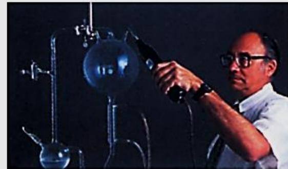
**Figura 1.10** S. L. Miller con un modello dell'apparecchio usato nel 1953 nell'esperimento sulla sintesi di aminoacidi, con una scarica elettrica, in un'atmosfera altamente riducente.
