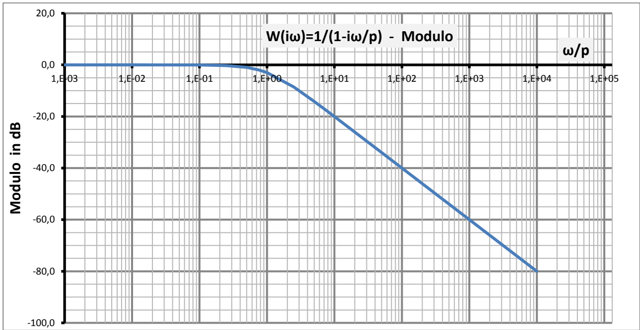
Figura 7 - Diagramma di Bode - Modulo
