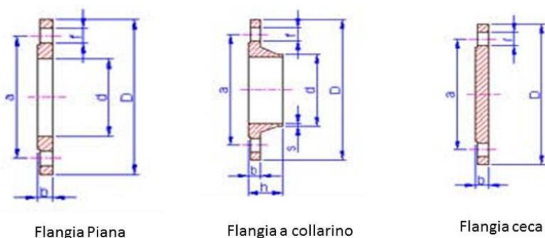
Figura 14 – Flange saldate secondo Normativa UNI EN 1092
