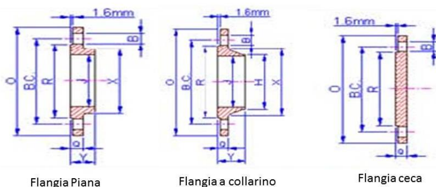
Figura 15 – Flange saldate secondo Normativa ANSI-ASME
