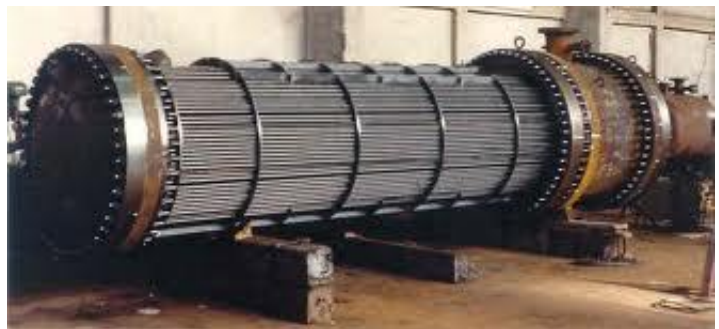
Figura 24 – Fascio tubiero con tubi ad U e con tubi dritti
