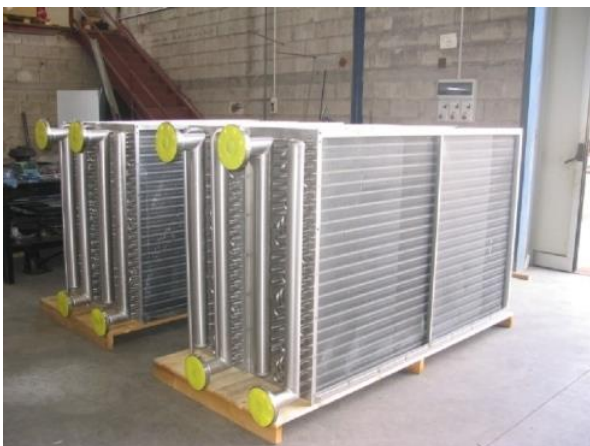
Figura 32 – Pacco alettato per "chiller" di alta potenza
