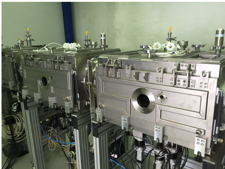
Figura 3 -sistema per la creazione di celle fotovoltaiche a film sottile
