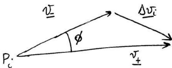
At  $P_i$   $(\Delta v_i)^2 = (v_-)^2 + (v_+)^2 - 2v_-v_+ \cos \phi$
